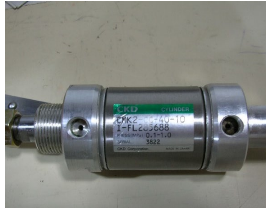
气缸漏气造成撕裂
